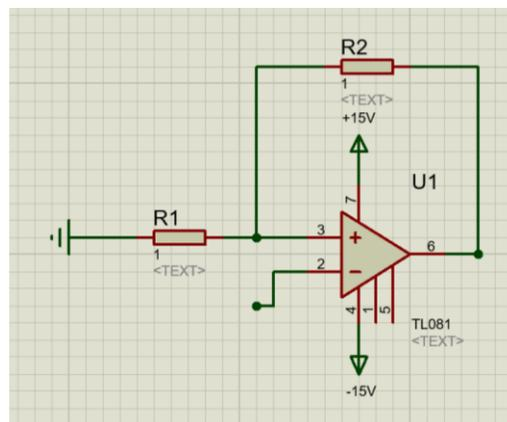
Fig.3. Schéma d'un comparateur à hystérésis donné aux étudiants lors du TP test. Ils doivent calculer les valeurs de R1 et R2 en fonction d'un cahier des charges puis placer et régler le GBF et l'oscilloscope afin de visualiser le cycle d'hystérésis.
