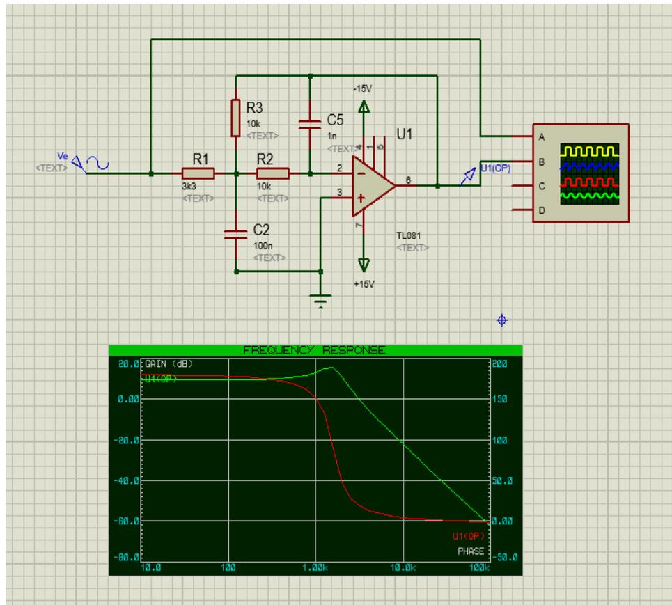
Fig.2. Schéma d'un filtre passe bas du second ordre dans proteus avec visualisation de l'entrée et la sortie avec un oscilloscope et le tracé du diagramme de Bode du filtre.
